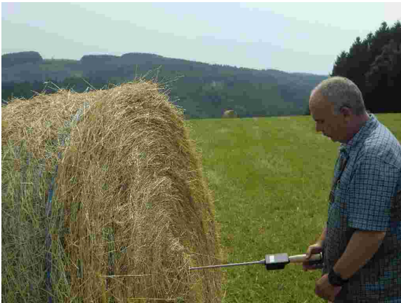
Feuchtemessung in einem Heuballen
